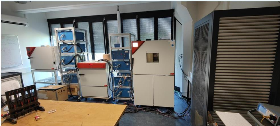
La plateforme **CARMEN** «**Caractérisation des AccumulateuRs et leur ModElisation**» est une plateforme qui permet d'étudier les systèmes de stockage d'énergie électrique. En effet, l'énergie électrique prend une place de plus en plus importante dans les véhicules pour un grand nombre d'applications dans les domaines des véhicules légers (véhicules hybrides et électriques) et ceux de transport urbain.
