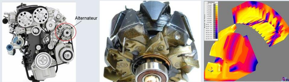
Modélisation multiphysique de l'alternateur-démarrateur : Machine à aimants permanents interne pour l'application Stop and Start
